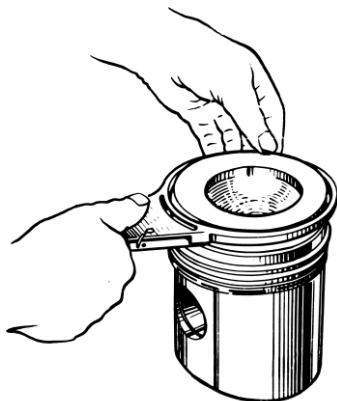
Рис. 95. Снятие и надевание поршневых колец на поршень
