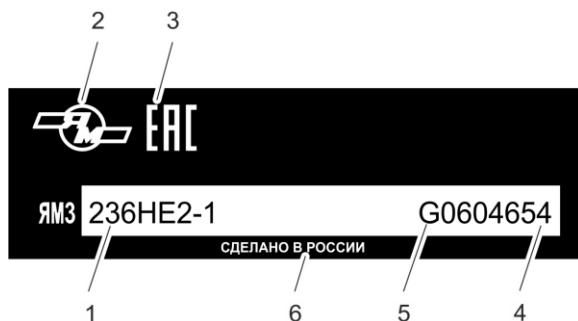
Рис. 53. Заводская табличка двигателя
